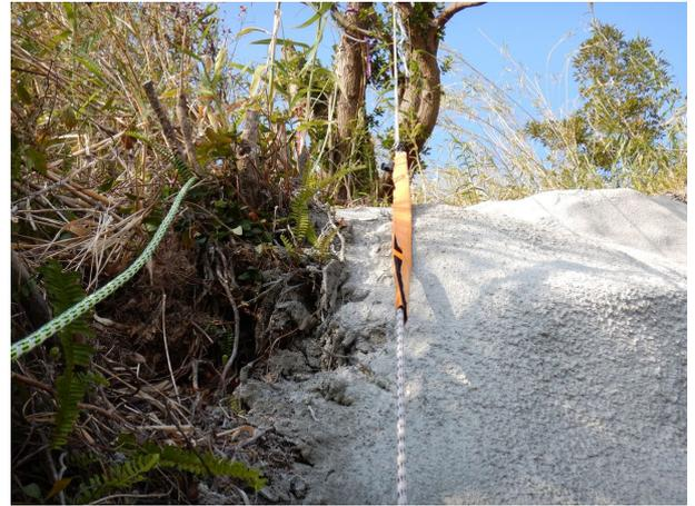
図4-6 ロープガードの使用例
