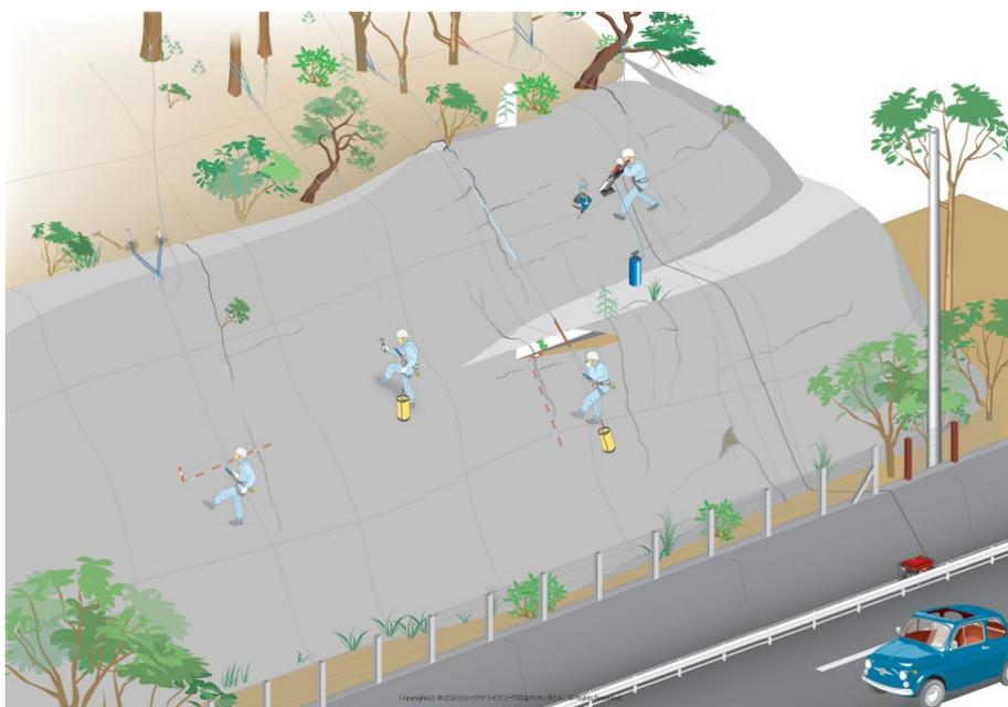
図2-1 作業模式図（法面でのロープアクセス調査／法面調査）
